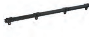
Cremagliera in nylon rinforzata 30x20 con anima di acciaio e accessori di installazione (confez. da 4 m) peso max cancello 400 kg
