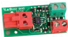
Interfaccia BUS XIB (nel caso si utilizzi la scheda E024S con fotocellula non BUS)
