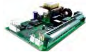
Scheda elettronica 624 BLD incorporata Caratt. tecniche a pag. 166
