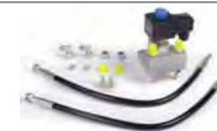
Gruppo antipanico (*) Consente l'apertura manuale della sbarra in caso di assenza di alimentazione elettrica
